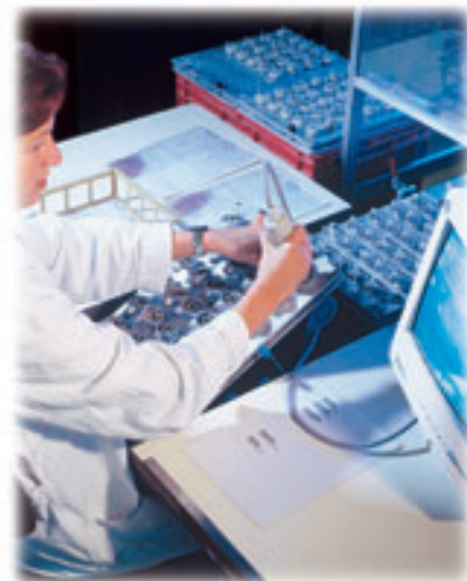
Endmontage der Temperaturfühler für Wärmehähler Typ PL mit Anschlusskopf nach EN 1434
