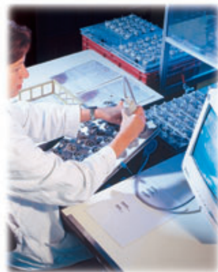
Endmontage der Temperaturfühler für Wärmemähler Typ PL mit Anschlusskopf nach EN 1434
