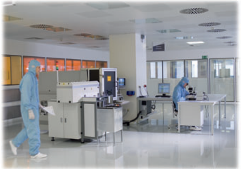
Sensorfertigung unter Reinraumbedingungen
